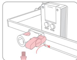
Verbinden Sie die Leuchte mit einem Ständer, indem Sie die obere Schraube des Ständers in das untere Loch der Leuchte einsetzen und den Ständerverbindungsknopf zum Festziehen im Uhrzeigersinn drehen.
