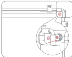
Setzen Sie die Barndoor auf das Licht und stellen Sie sicher, dass die Schraubenlöcher an den vier Ecken mit den 2 Schraubmutter ausgerichtet sind.
