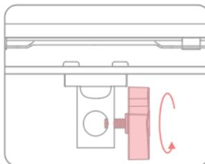
Drehen Sie den Verbindungsknopf des Ständers gegen den Uhrzeigersinn, um ihn zu lösen.
