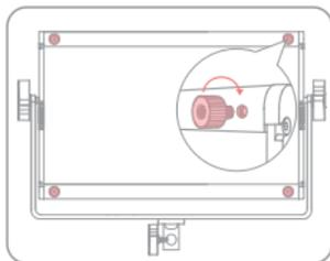
Setzen Sie die vier 2 Schraubenmutter in die Schraubenlöcher des Leuchtenkörpers ein und drehen Sie sie nacheinander im Uhrzeigersinn, bis sie fest sitzen.
