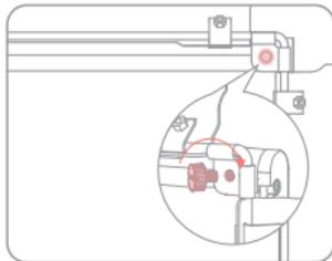
Setzen Sie die vier 2 Schrauben in die 1 Schraubenmutter ein und drehen Sie sie im Uhrzeigersinn, um sie nacheinander festzuziehen.
